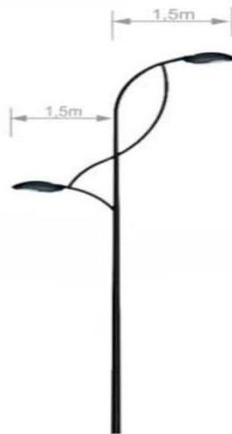
Figura 02: Modelo de poste de iluminação
