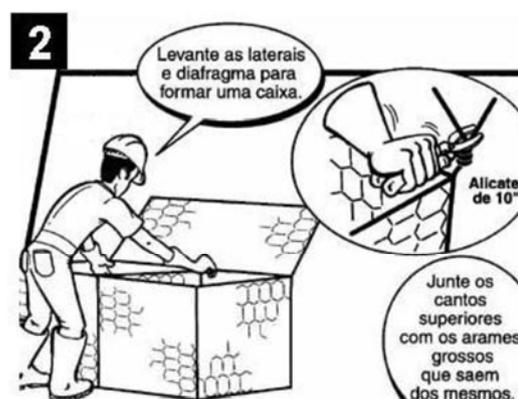
Figura 2. Posicionamento dos painéis laterais e diafragmas.
